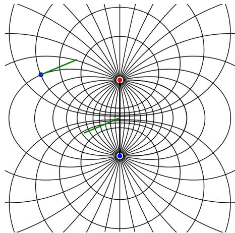
Die Kraft auf den Monopol in Abbildung 1 zeigt am Dipol vorbei, d.h. Aktions- und Reaktionskraft sind parallel gerichtet, liegen aber auf verschiedenen Wirkungslinien.
