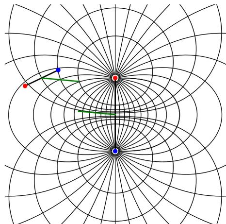
Werden die Dipole in der Simulation verkürzt, siehe Abb. 3, so ändert sich wenig an dieser Aussage, denn für Punktdipole lässt sie sich exakt nachrechnen.
