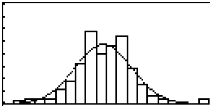
Figur 2: Histogramm der Münzmassen mit Gauss'scher Glockenkurve Abszisse 3.90 g bis 4.10 g (Klassenbreite 0.01 g) Ordinate 0 bis 40 (Häufigkeit)
