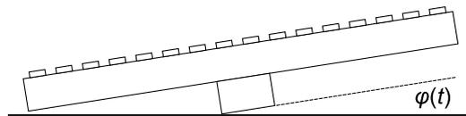
Abbildung 1: Links: Eine versehentlich angestossene Flasche wackelt. Sei  $\varphi(t)$  der momentane Kippwinkel um die Drehachse  $D$  und  $\alpha$  der Winkel Flaschenboden-Drehachse-Schwerpunkt  $S$ . Die Bewegung laufe in einer vertikalen Ebene ab und sei links/rechts symmetrisch. Oben: Ein ‘Lego-Wackler’ schwingt kontrollierter und kann durch Aufstecken weiterer Bausteine verändert werden.
