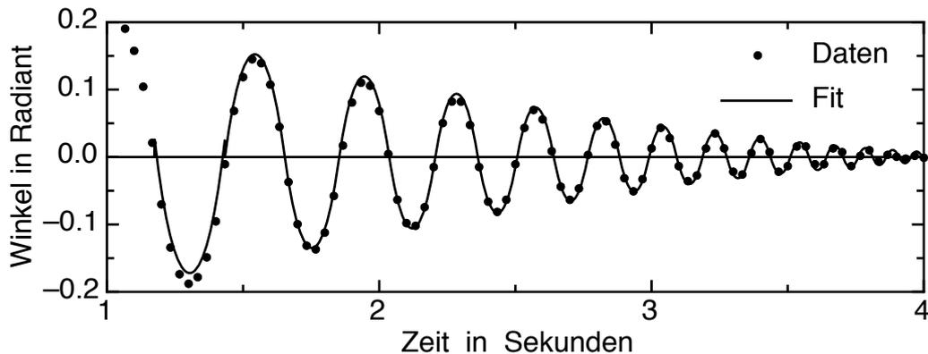
Abbildung 2: Bewegung  $\varphi(t)$  eines 'Lego-Wacklers' mit Fitfunktion. Die Schwingung wurde mit einem iPhone gefilmt und mit Logger Pro digitalisiert. Der Fit besteht aus zusammengefügteten cosh-Funktionen mit total fünf Fitparametern. Die Wackelfrequenz steigt mit abnehmender Amplitude.
